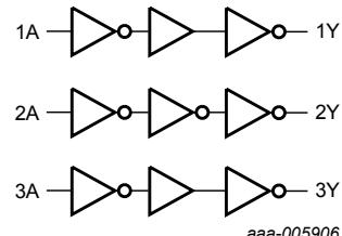
**Fig. 3. Logic diagram**
