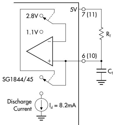
**FIGURE 20.** — OSCILLATOR CONNECTION
