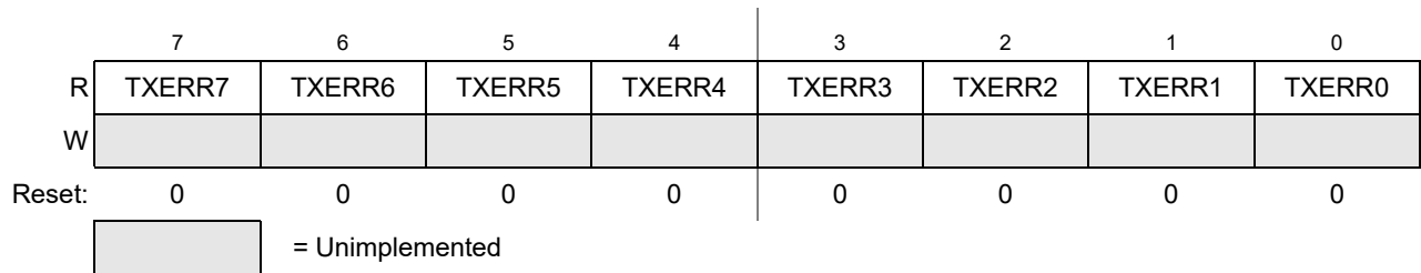
Figure 18-19. MSCAN Transmit Error Counter (CANTXERR)
