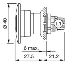
L1 = Löt-/Steckanschluss 2.8 x 0.5 mm
