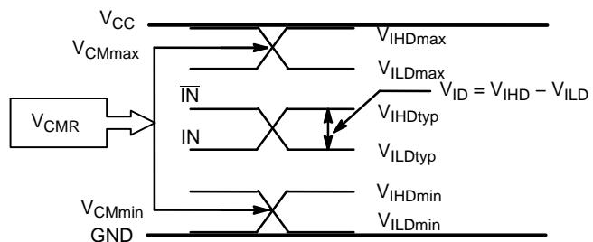
Figure 10.  $V_{CMR}$  Diagram
