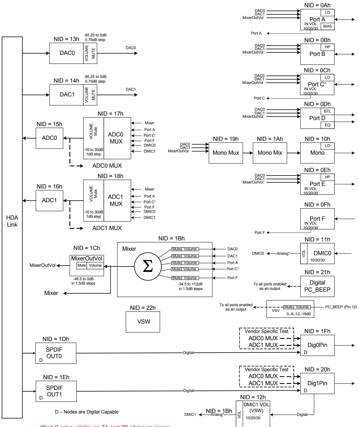
Figure 16. Widget Diagram
