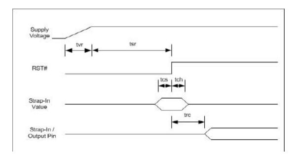
Figure 29. Reset Timing
