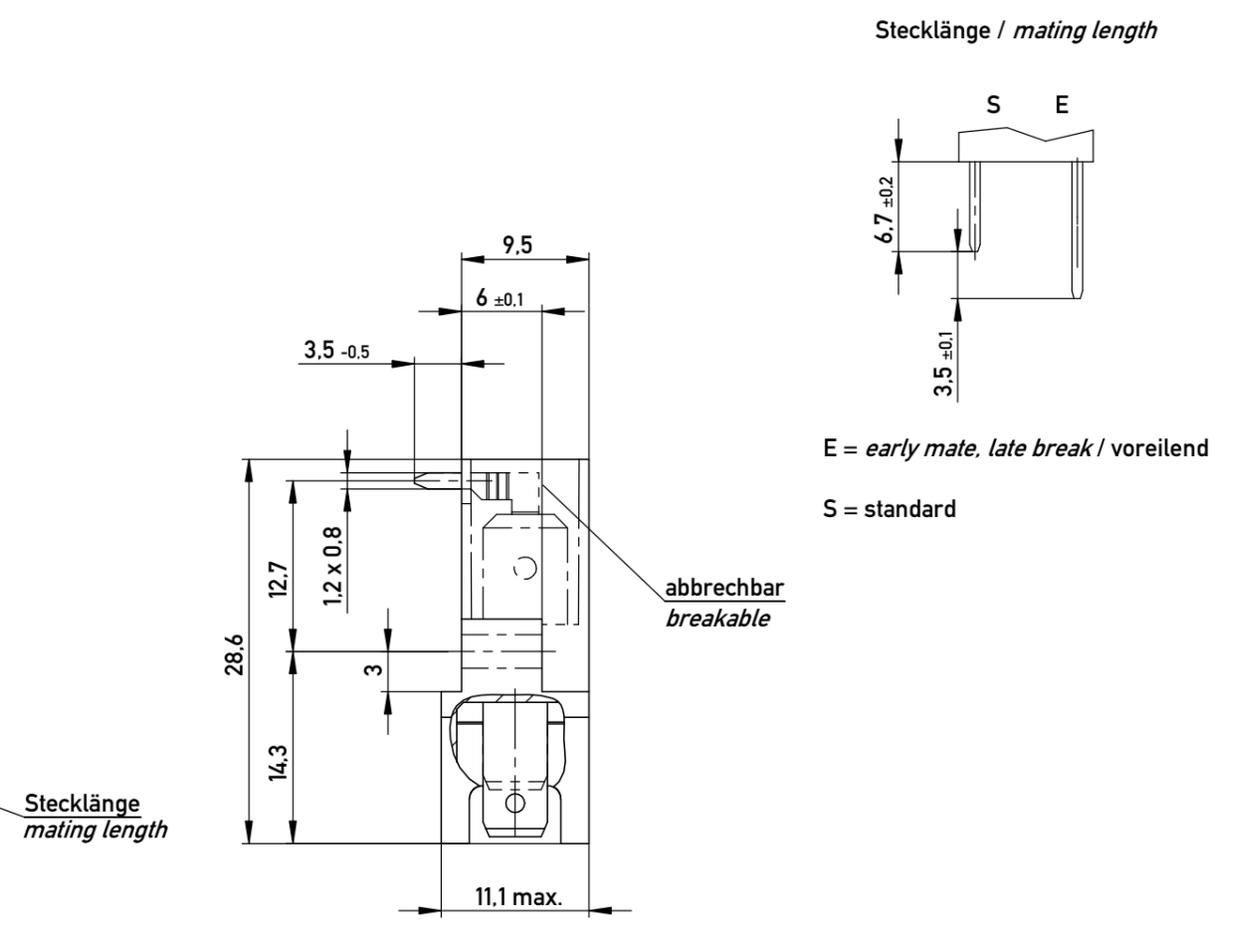
Lötanschluss 0,8 x 1,2 mm / solder terminal 0,8 x 1,2 mm
