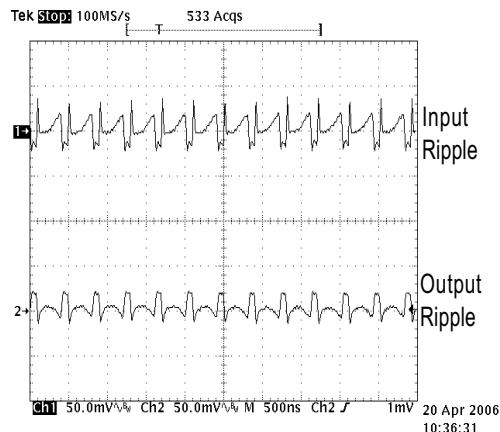
Ripple 1X Flash 700mA,  $V_{IN}=4.2V$
