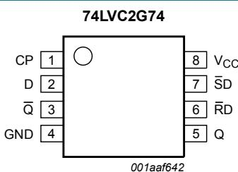
Fig. 4. Pin configuration SOT505-2 (TSSOP8) and SOT765-1 (VSSOP8)
