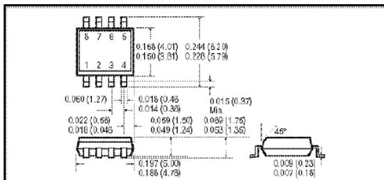
**SOIC-8 Package Pin Configuration**
