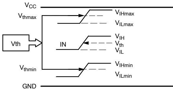
**Figure 6. V<sub>th</sub> Diagram**
