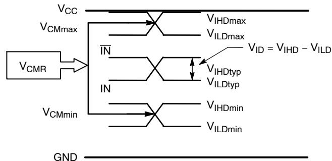
**Figure 9. V<sub>CMR</sub> Diagram**
