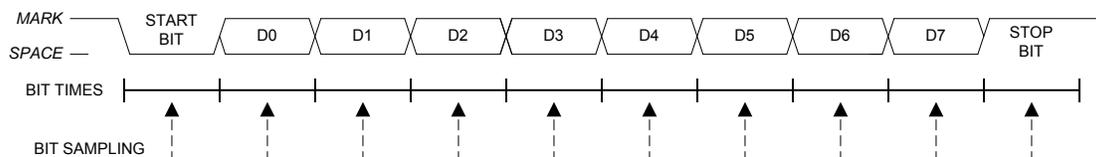
**Figure 25.4. 8-Bit UART Timing Diagram**
