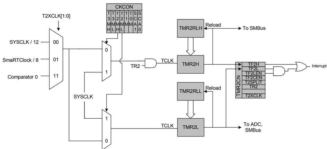
**Figure 27.5. Timer 2 8-Bit Mode Block Diagram**
