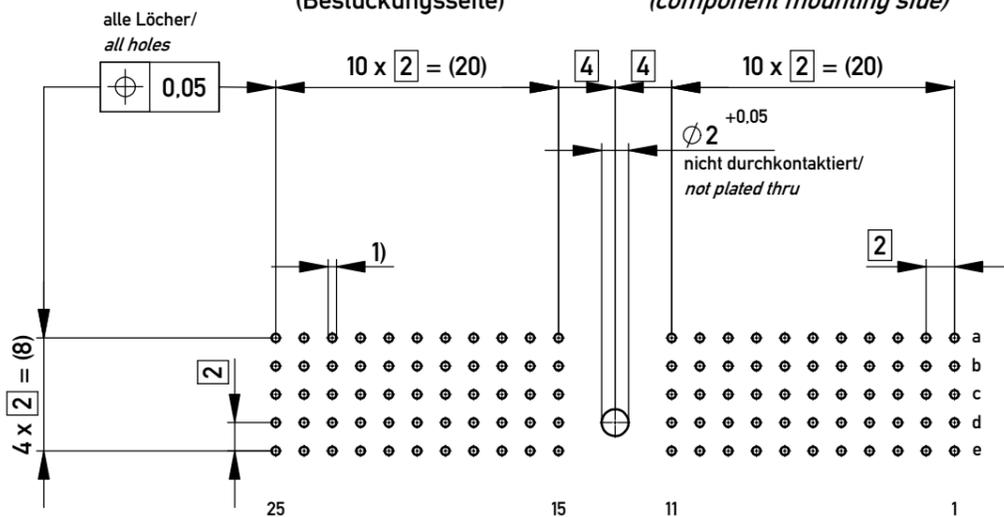
1)  $\phi 0,6 \pm 0,05$  Durchmesser des metallisierten Loches
