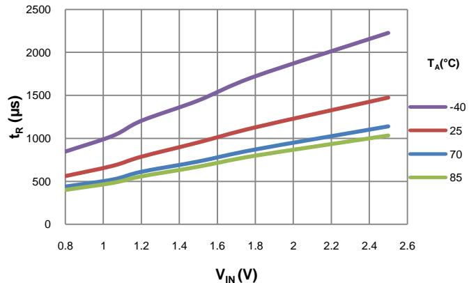
$t_{\text{R}}$  vs  $V_{\text{IN}}$ ,  $V_{\text{BIAS}}=5.5\text{V}$
