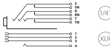
Wiring: Example of NCJ9FI-H
