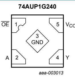
Fig. 7. Pin configuration SOT1226 (X2SON5)
