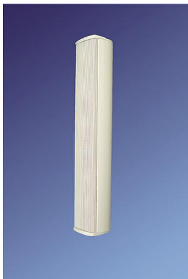
**Sehr schlanke Lautsprecherzeile** mit 100-V-Technik, bestückt mit vier 5-cm-Lautsprechern. Wandbefestigung mit Montagewinkeln an den Stirnseiten oder mit optionaler Gelenkhalterung. Nach Montage in alle Richtungen schwenkbar. Weiß lackiertes Aluminiumgehäuse und Abdeckgitter (RAL 9010).
