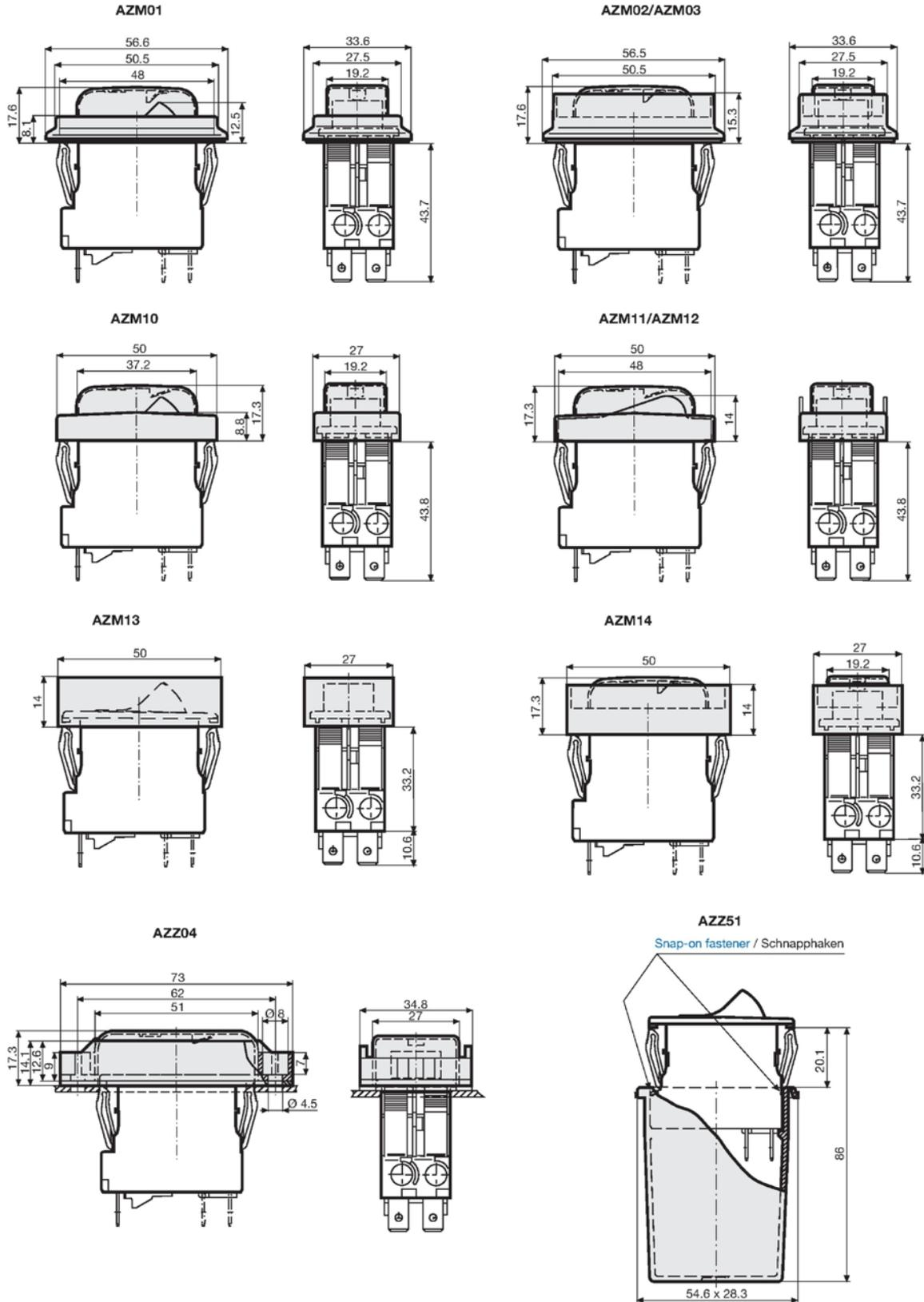
**CIRCUIT BREAKERS FOR EQUIPMENT, 2 POLE, ROCKER**
