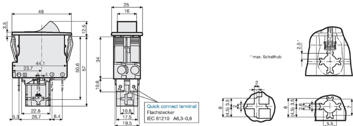
**CIRCUIT BREAKERS FOR EQUIPMENT, 2 POLE, ROCKER**
