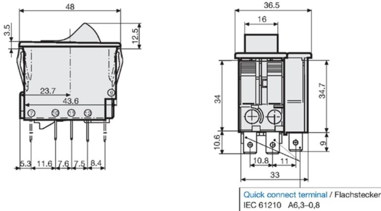
**Undervoltage release, remote trip release / Unterspannungsauslösung, Fernauslösung**
