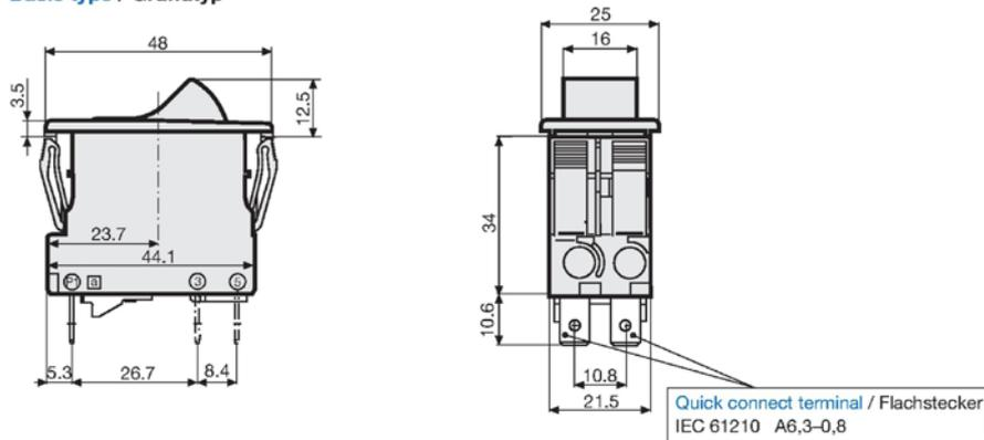
**Undervoltage release, remote trip release / Unterspannungsauslösung, Fernauslösung**
