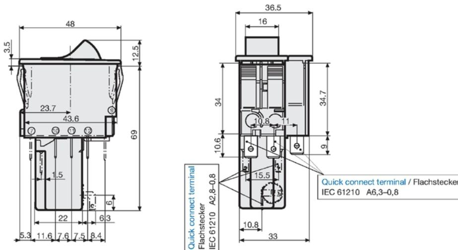
**Mechanical lock-out latch / Mechanische Schaltperre**
