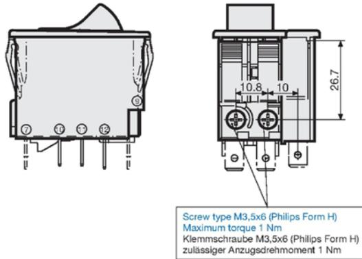
**Cut-out and pin-out / Montageöffnung und Anschlussbelegung**
