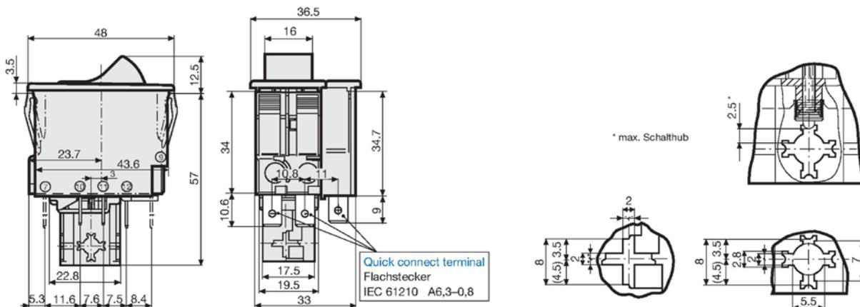
**CIRCUIT BREAKERS FOR EQUIPMENT, 2 POLE, ROCKER
