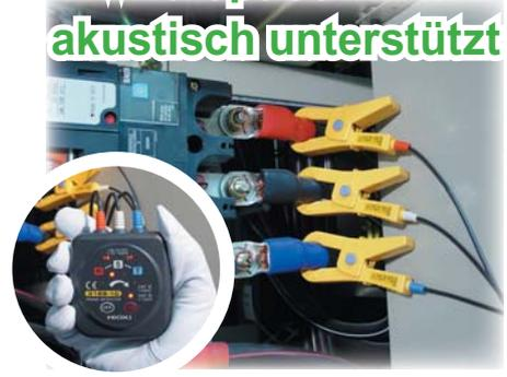
Die Drehfeldrichtungsanzeiger der 3129 Serie werden für die Phasenprüfung und Prüfung an spannungsführenden Leitungen in 3-Phasen Wechselstromkreisen eingesetzt. Die Spannungserkennung basiert auf elektrostatischer Feldmessung. Beim Messergebnis werden Tonsignale ausgegeben, und die roten Dioden blinken in Drehfeldrichtung.
