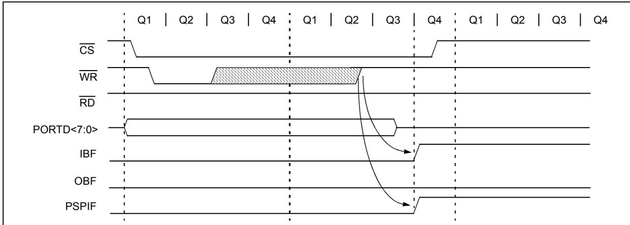
**FIGURE 11-4: PARALLEL SLAVE PORT READ WAVEFORMS**
