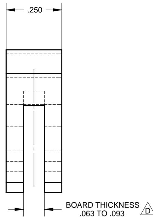
**EJECTOR ROLL PIN DETAIL**
