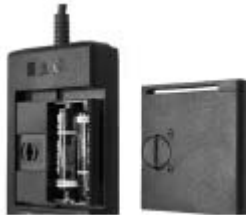
Abb. 6 - RÜCKSEITE DES ACF-3000SR MIT ABGENOMMENEN BATTERIEFACHDECKEL
