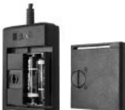
Fig. 6 – PARTE POSTERIOR DEL ACF-3000 SR CON LA TAPA DE LA BATERÍA QUITADA
