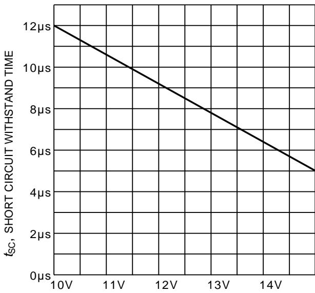
$V_{GE}$ , GATE-EMITTER VOLTAGE
