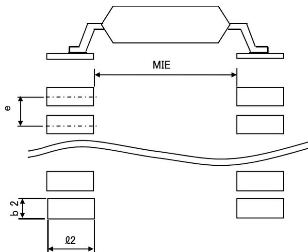
SOP8, SSOP-B8, SOP-J8, MSOP8
