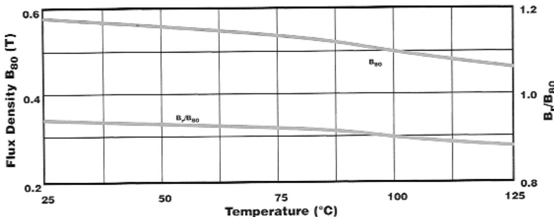
†  $B_{80}$  - Flux Density @ 80 A/m
