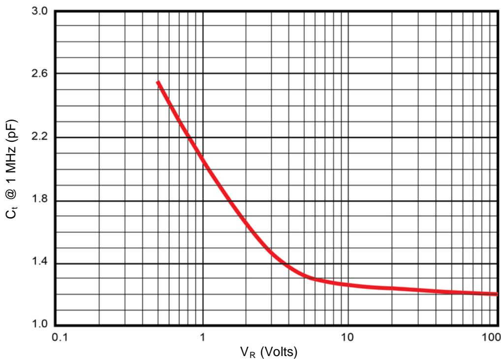
**FIGURE 2 – CAPACITANCE (TYPICAL)**
