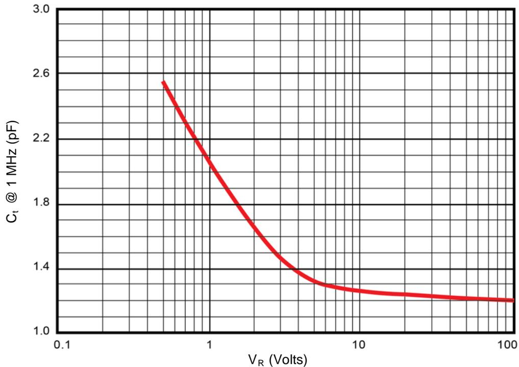
FIGURE 2 - CAPACITANCE (TYPICAL)
